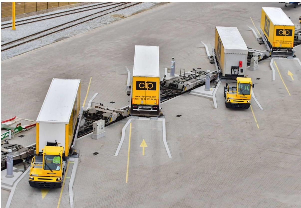
Rysunek 100. Przeładunek naczep przy użyciu stacji Lohr Railway System w CLIP Rail Mega Hub Intermodal w Swarzędzu
